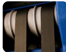
Interaction entre la courroie plate d'acier gainé et la poulie bombée.
