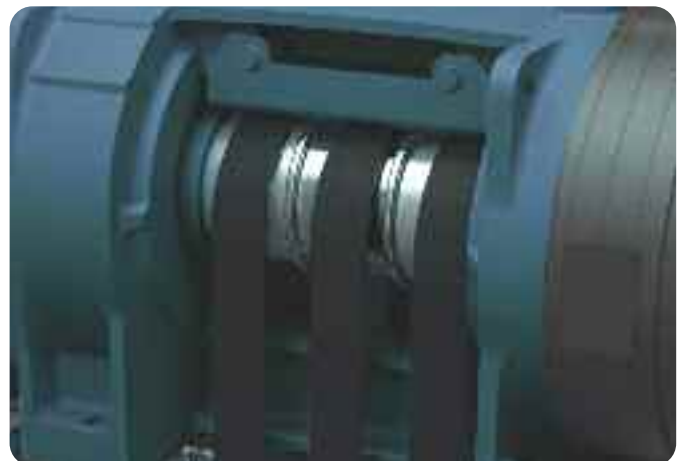
Interaction entre la courroie plate d'acier gainé et la poulie bombée.
