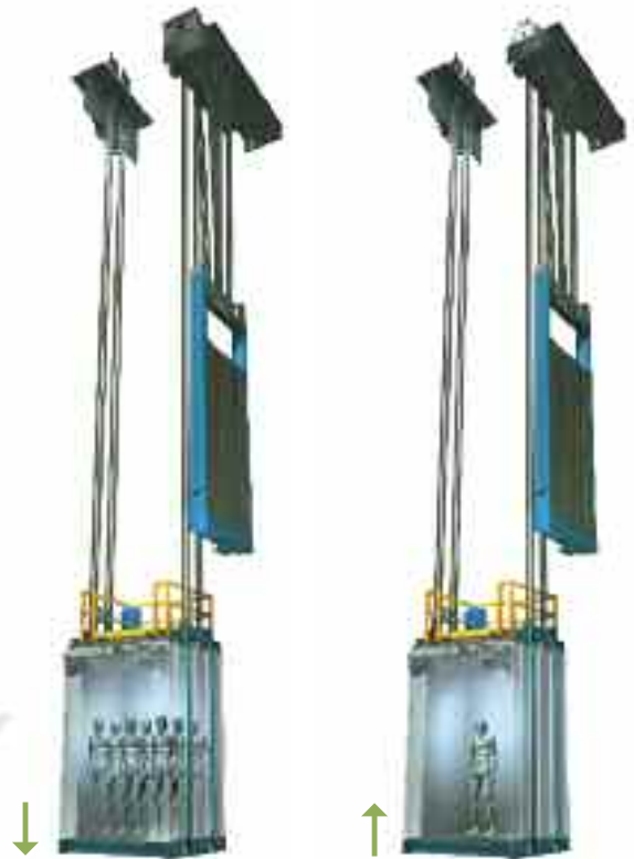
Cabine très chargée, en descente
