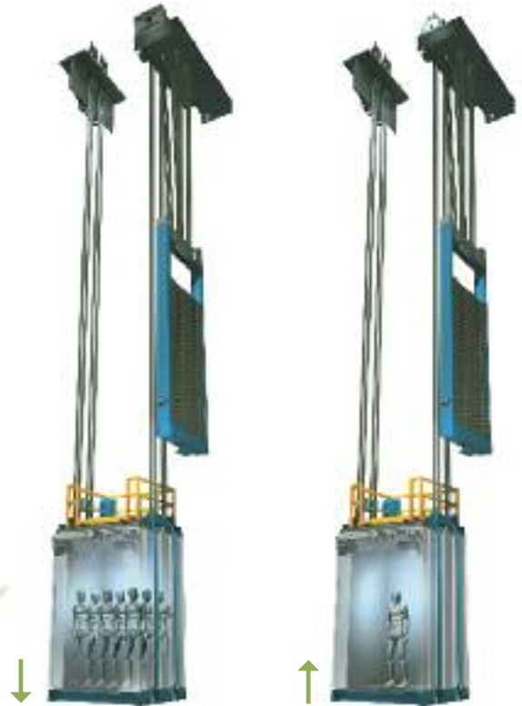
Cabine très chargée, en descente
