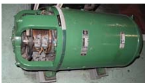
電動機発電機
