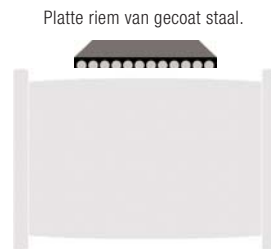
Automatisch gecentreerd dankzij de licht gebogen tractiepulley.
