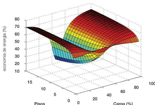
Economia de energia com o drive ReGen em comparação ao drive não-regenerativo, em função da carga dentro da cabina e quantidade de pisos (de 1 a 20).
