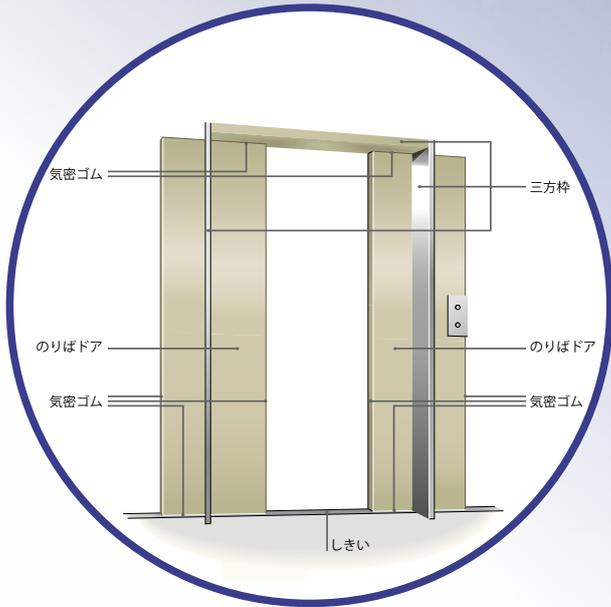
火災等によって発生した煙がエレベーター昇降路を通じて他階に広がらないように、乗場ドアには気密材が設置されています。
