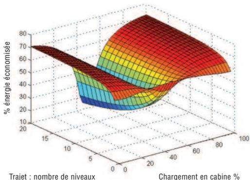
Pourcentage d'énergie économisée durant le déplacement de l'ascenseur en utilisant un système d'entraînement régénératif (au lieu d'un non régénératif). Le graphe en 3 dimensions montre les économies d'énergie en fonction du pourcentage de charge en cabine (de 0 à 100%), et de la distance parcourue en nombre d'étage (de 1 à 20 niveaux).
