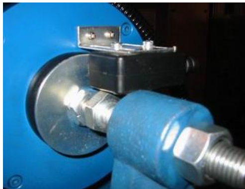
图示 4-1 : 橡胶防护套在安装支架和开关之间, 开关无法完全紧固
