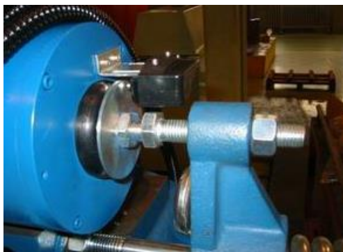
图示 4-1 : 橡胶防护套在安装支架和开关之间, 开关无法完全紧固
