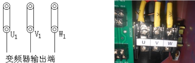
图 1 NEW BOMCO W 曳引机接线图
