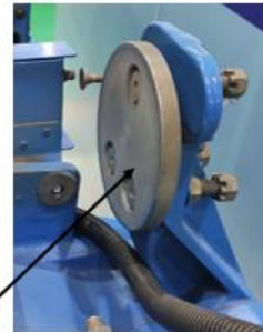
检查并清洁吸合圆盘和电磁铁的接触面
