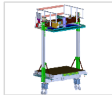
Plate-forme et plancher renforcés par un plancher de 3-4 mm, une plaque d'acier de 6 mm et une plate-forme de 2-3 mm.
