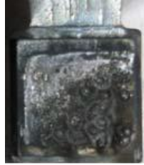
接点が摩耗している状態
