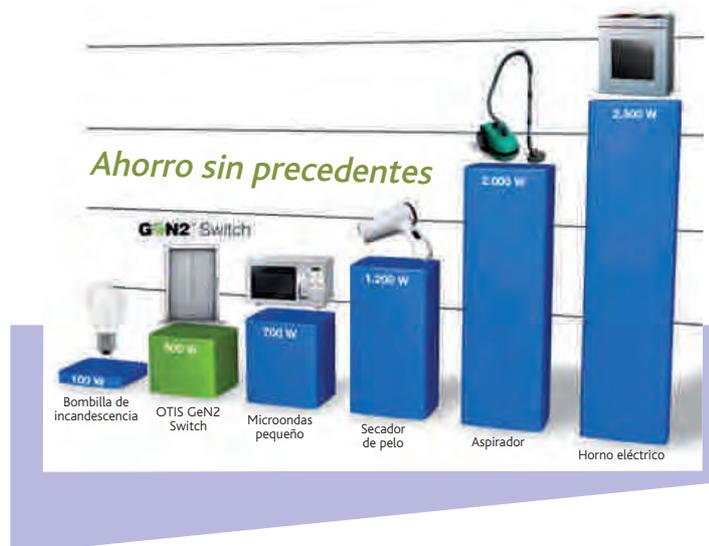
Dispone de un sistema de regeneración de energía, de forma que cuando el ascensor desciende con carga o cuando sube con carga parcial, la fuerza de la gravedad genera energía que es almacenada en el sistema de acumulación que dispone. Esta energía es utilizada en el siguiente viaje, evitando consumirla de la red.
