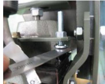
<アクチュエーター部と押しボルトの間の測定>
