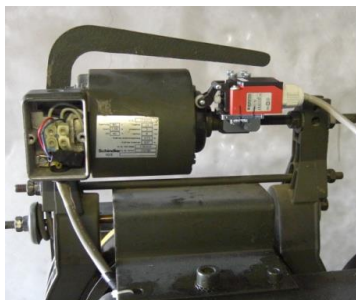
<KKBスイッチ取付け状態 側面から見た写真>
