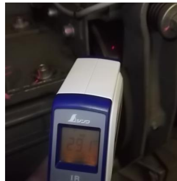
<③ブレーキドラム上表面部>
