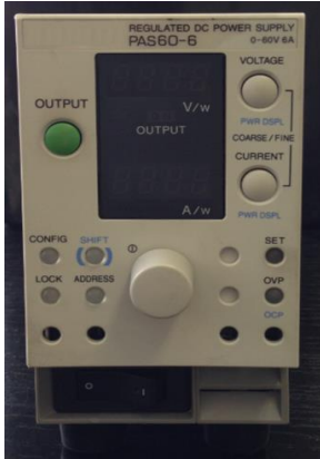
項目④で使用く直流電源装置>
