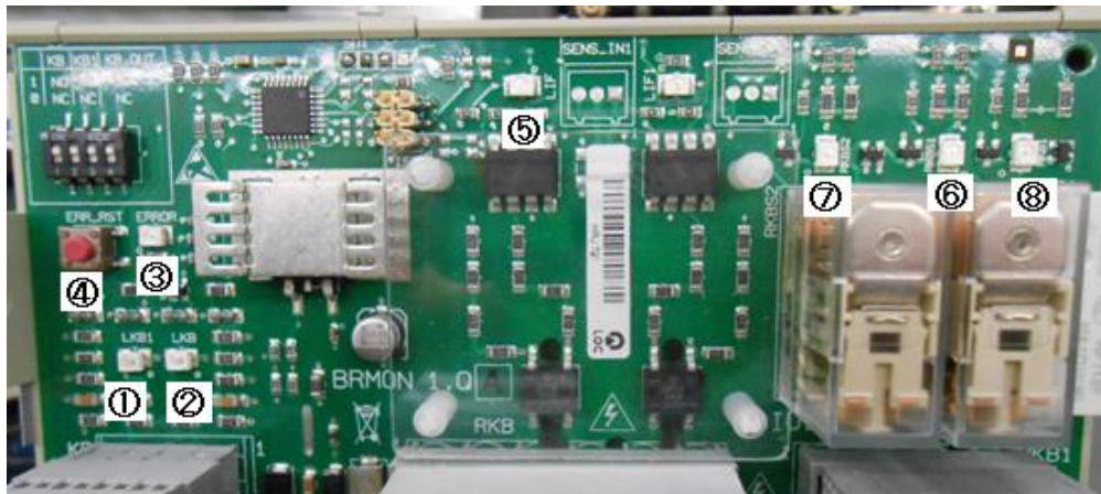
<BRMON基板のLED配置図>
