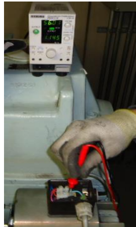
<70%電圧での吸引試験>
