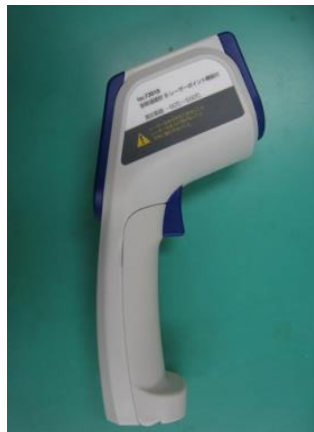
項目⑥で使用く非接触型温度計> 使用温度計測機器例 測定エリアサイズ12cm:φ1cm
