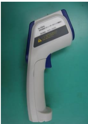
項目⑥で使用く非接触型温度計> 使用温度計測機器例 測定エリアサイズ12cm:φ1cm
