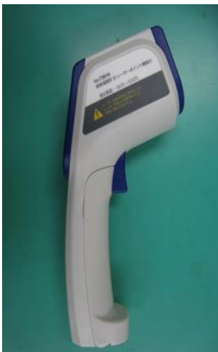
項目⑥で使用く非接触型温度計> 使用温度計測機器例 測定エリアサイズ12cm:φ1cm
