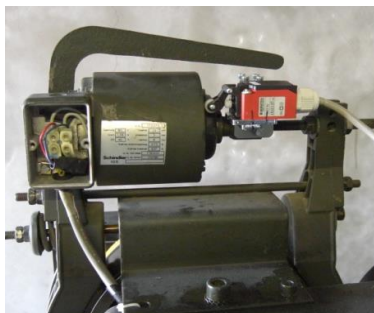
<KKBスイッチ取付け状態 側面から見た写真>
