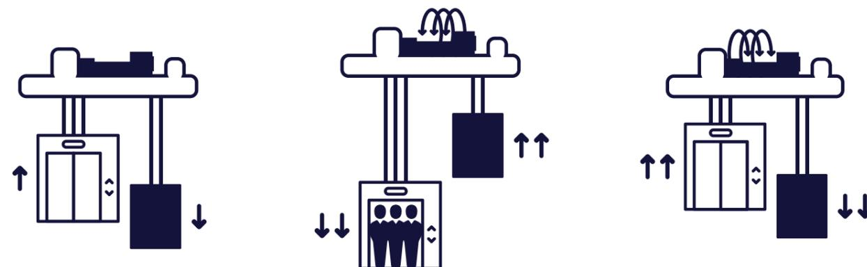
En un ascensor la cabina está unida a un contrapeso a través de una polea. Cuando el contrapeso baja, la cabina sube, y cuando el contrapeso sube, la cabina baja.
