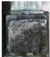
接点が摩耗している状態
