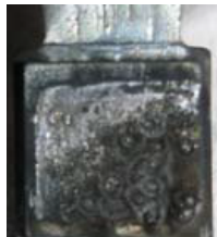
接点が摩耗している状態
